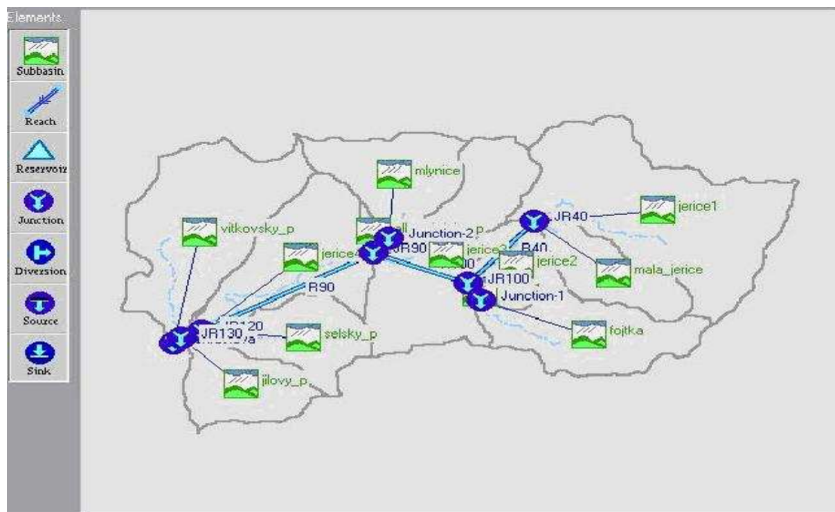
Obr. 4.1 Schéma modelu povodí Jeřice v programu HEC-HMS
