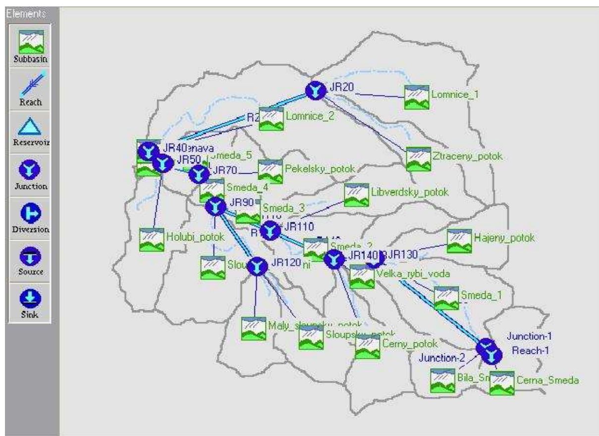
Obr. 6.1 Schéma modelu povodí Smědé v programu HEC-HMS
